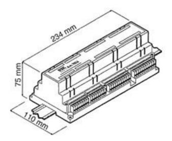
Группы контактов реле управляются запитывающимися терминалов C1/SN1, C2/SN2, C3/SN3 и C4/SN4. На какое плечо запитывающихся терминалов был подан управляющий сигнал, в таком положении и остаются контакты реле после срабатывания, до тех пор, пока не появится управляющий сигнал на одном из других плеч.
