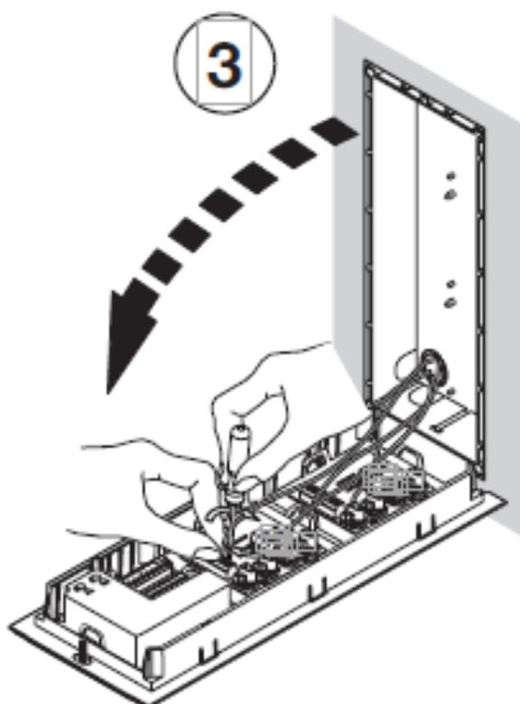
Разверните держатель модуля и подключите провода.
