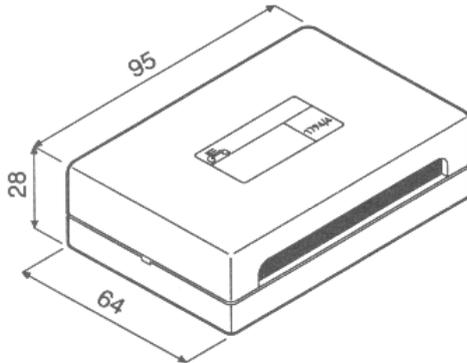
Видеораспределитель имеет 4 выхода для распределения магистрального видеосигнала на 4 направления и 2 терминала (вход/выход) для подключения к магистральному кабелю.
