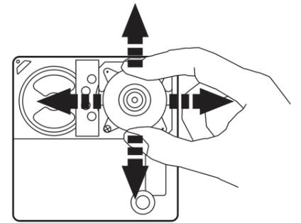
Отрегулируйте положение видеокамеры
